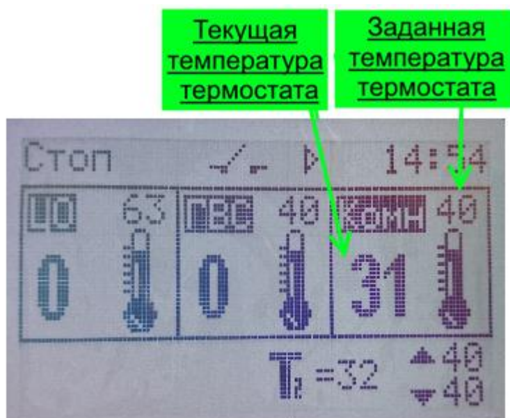
Рисунок 4 – Вид главного экрана модуля AIR GSM в режиме термостата
